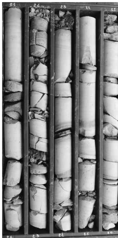
Fig. 4. Carota rocciosa dal metro 20 al metro 25.
